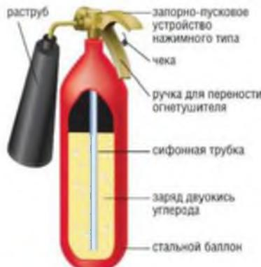
Устройство с зарядом двуокиси углерода ( $\text{CO}_2$ ) сжиженной, это позволяет снижать температуру и вытеснять кислород в месте возгорания.
