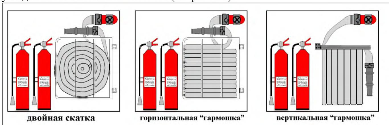
Рис. № 5 Порядок укладки пожарного рукава в шкаф.
