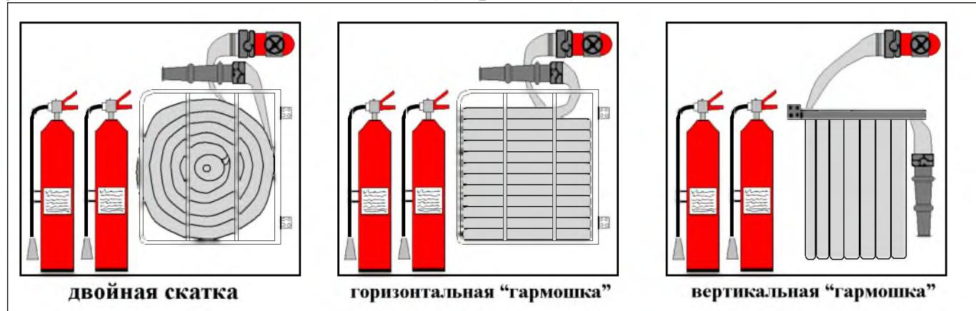
Рис. № 5 Порядок укладывания пожарного рукава в шкаф.
